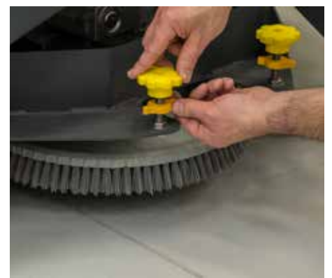
Facilité d'entretien : les molettes de réglage sont clairement identifiées par une couleur jaune
