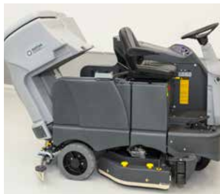
Réservoir de récupération inclinable et amovible
