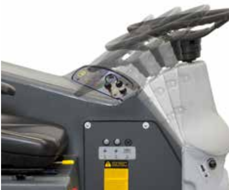
Volant inclinable pour faciliter la montée/descente de l'opérateur et poste de conduite ergonomique garantissant confort et sécurité
