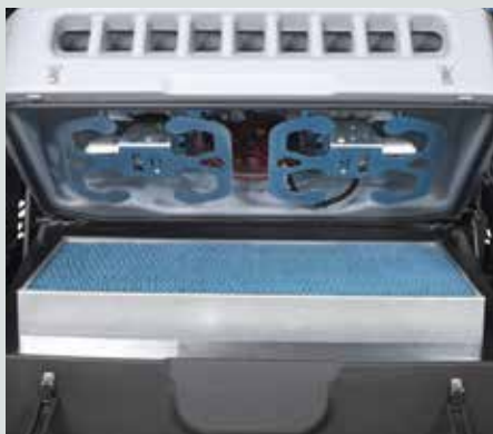
Le mécanisme de secouage temporisé multi-fréquence nettoie efficacement le filtre
